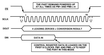
Figure 13. Normal-Mode Operation
