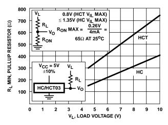
FIGURE 2. MINIMUM RESISTIVE LOAD vs LOAD VOLTAGE
