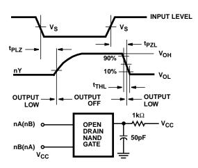
FIGURE 1. TRANSITION TIMES, PROPAGATION DELAY TIMES, AND TEST CIRCUIT
